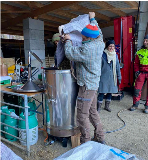
Einfüllen des zerkleinerten Arvenholzmaterials in die Chromstahl-Destille
