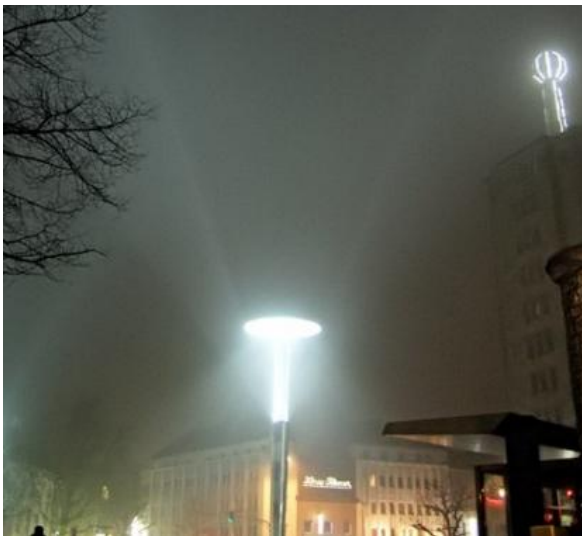
Abbildung 8: Konventionelle Strassenbeleuchtung mit geringer Lichtabschirmung nach oben (Hattenbach 2007)
