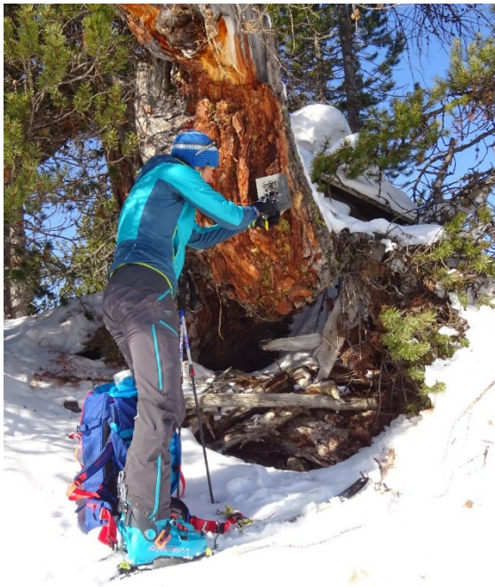
Mitarbeiterin der ZHAW beim Auslesen einer Kamera des automatischen Zählsystems zum Besuchermonitoring Piz Dora (Bild: Yves Schwyzer).
