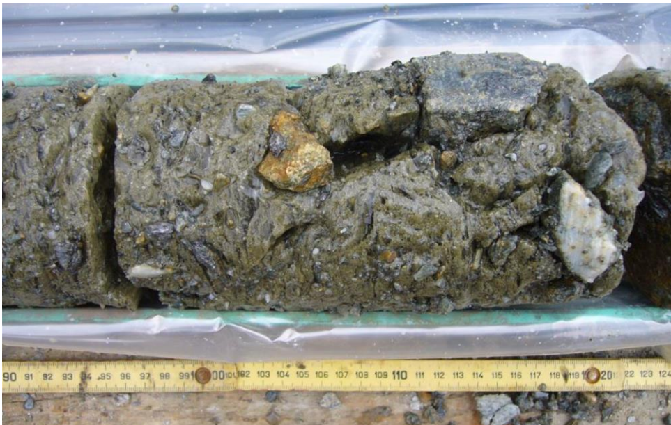
Abbildung 7: Ausschnitt eines Bohrkerns des Lazaun-Blockgletschers (Süd-Tirol) nach Mair et al. (2015). Dieser Eiskern befindet sich in 20m Tiefe.
