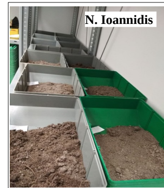
Abbildung 5 Bodenproben im Labor in großen Behältern zum trocknen ausgelegt.
