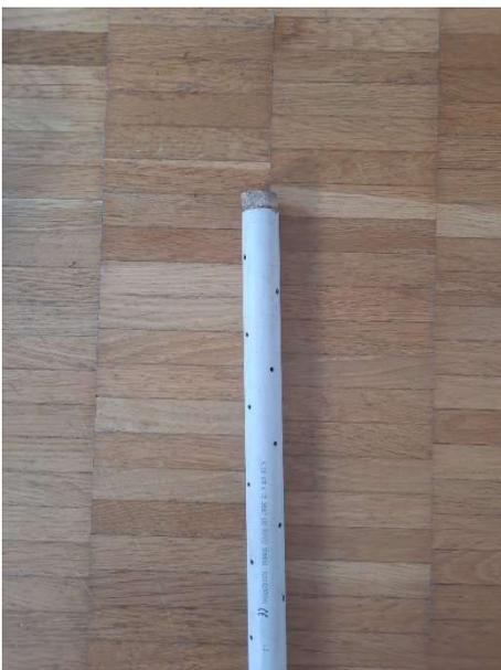
Abbildung 4 Beispiel einer perforierten PVC-Röhre, mit welcher der Wasserstand im Boden gemessen werden kann.
