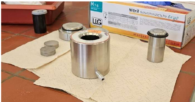
Abbildung 5: Pressform aus Edelstahl für das Herstellen der Pillen für die XRF-Messung
