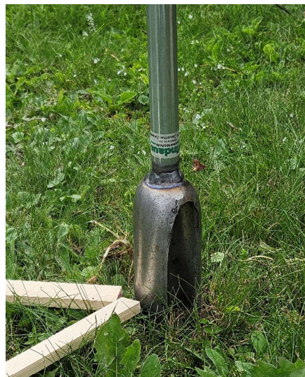
Abbildung 11: Werkzeug zur Entnahme der Bodenprobe
