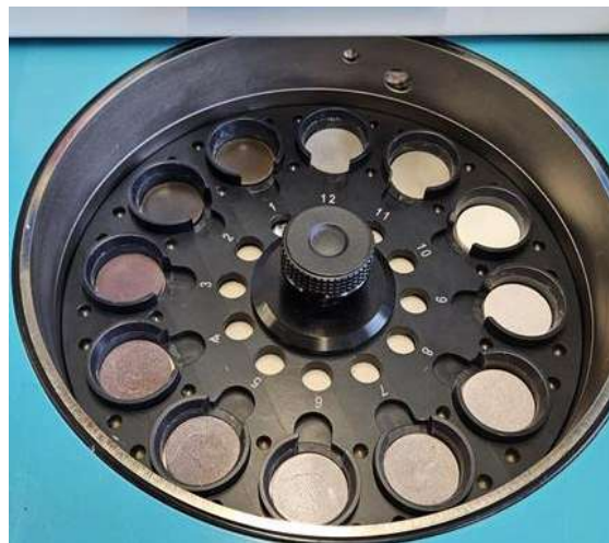
Abbildung 6: Kalibration-Pillen von Herrn Heeb im XRF-Gerät der EAWAG
