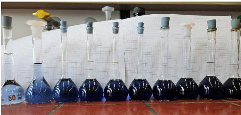
Abbildung 48: Lösungen für die Kalibrierungsgerade nach der Reaktion mit dem Molybdän
