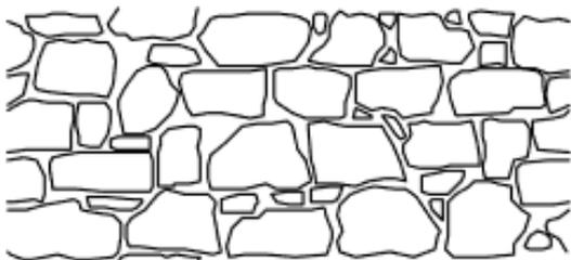
Abb. 31: Gemischtmauerwerkstyp MX 1 (Tiefbauamt Graubünden (Hrsg.) 2013: 36).
