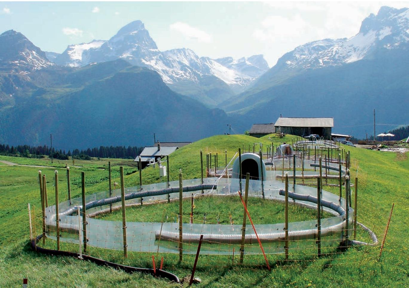
Abb. 1: Freiluftbegasungsanlage auf der Alp Flix.
