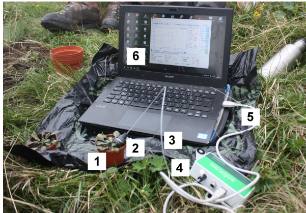
Versuchsaufbau: (1) Pflanzenexemplar (hier Arabidopsis thaliana ), (2) Magnetische Blatthaltevorrichtung, (3) Lichtleiter, (4) JUNIOR-PAM, (5) USB-Kabel, (6) Laptop mit Software WinControl-3 (Foto: Dominik Ranker)
