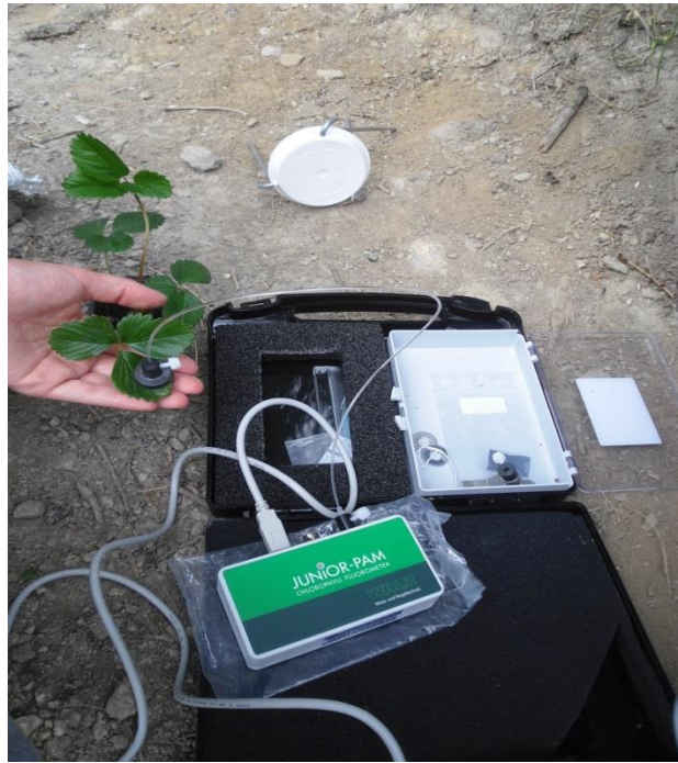
Abbildung 5: Aufbau der Apparatur (Junior-PAM) mit eingespanntem Blatt.
