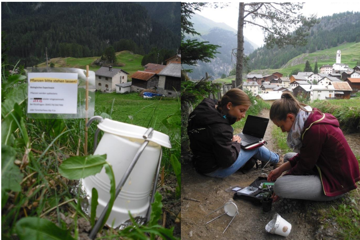
Abbildung 4: Standort D (auf ca. 1600 Höhenmetern); links: aufgebaute Apparatur zur Abdunkelung der Pflanzen; rechts: Messungen mittels Junior-PAM nach 30 minütiger Verdunkelung der Versuchspflanzen.
