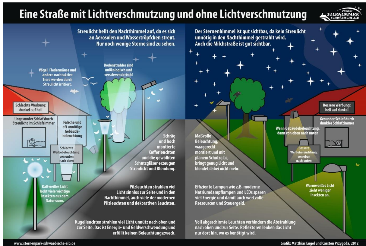
Abbildung 4: Vergleich von ineffizienter und effizienter Beleuchtung
