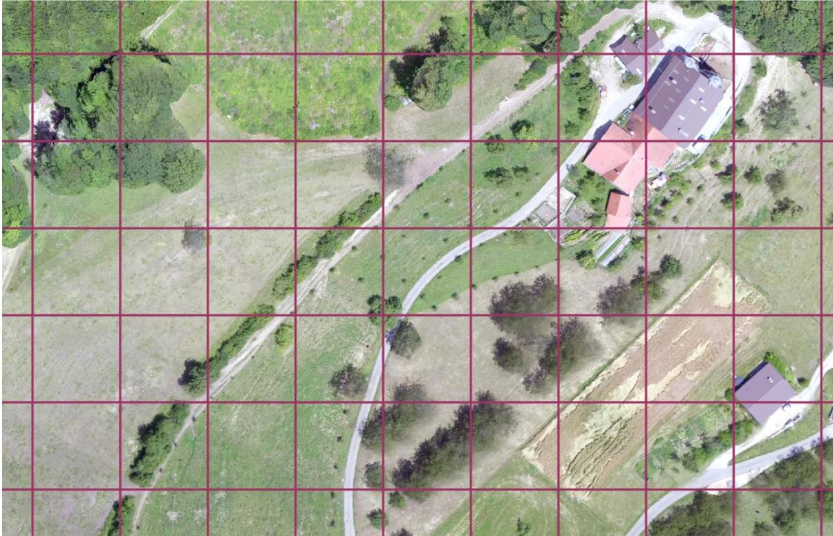
Abbildung 5: Ausschnitt der Orthofotos zusammen mit dem verwendeten Rasternetz mit einer Zellgrösse von 40 m\*40 m. Bei der Erfassung der Kleinstrukturen wurde weiter hinein gezoomt, sodass der gezeigte Bildausschnitt einer einzigen Zelle entspricht.
