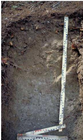
Abbildung 22: Profil 9141 mit braunem B- und grauem C-Horizont
