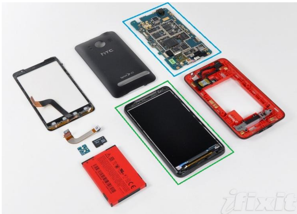
Abbildung 5: Einzelteile des Evo 4G, abgeändert. Oben blau eingerahmt die Platine, die ‚Technikzentrale‘ des Gerätes. Grün: der Touchscreen, auf welchen im Folgenden als erstes eingegangen wird. Weiterhin sind z. B. Gehäuseschale und Batterie zu erkennen.
