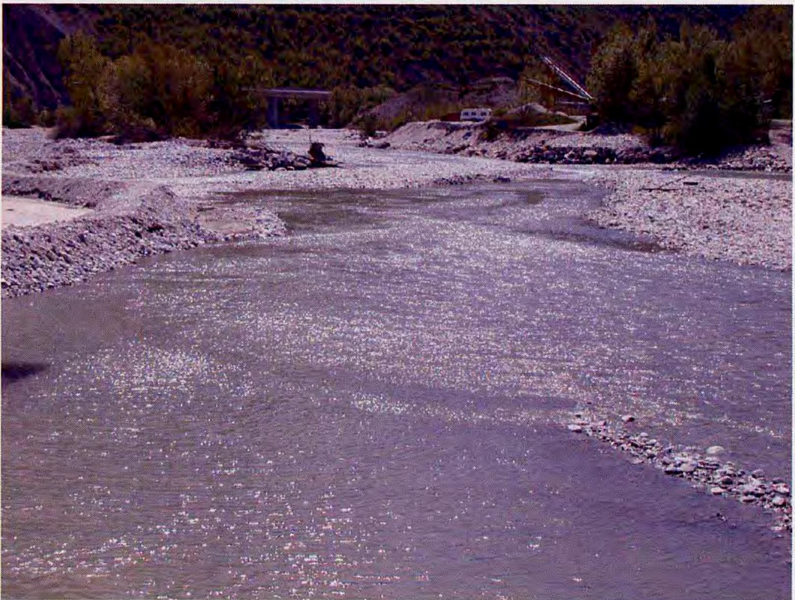
**Abb. 24:** Ile Falcon – Veränderung der Strukturen durch regelmäßige Kiesentnahme (Baumann 2002)
