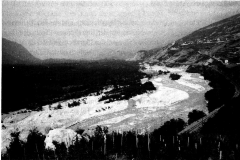
Bild 1. Blick von Leuk talabwärts. Vom Schwemmkegel des Illgrabens wird der Rotten an den rechten Talhang gedrängt. Vom Pfywald (links) wird der Fluss durch einen langgezogenen Damm getrennt. In Bildmitte ist eines der Kieswerke zu erkennen.
