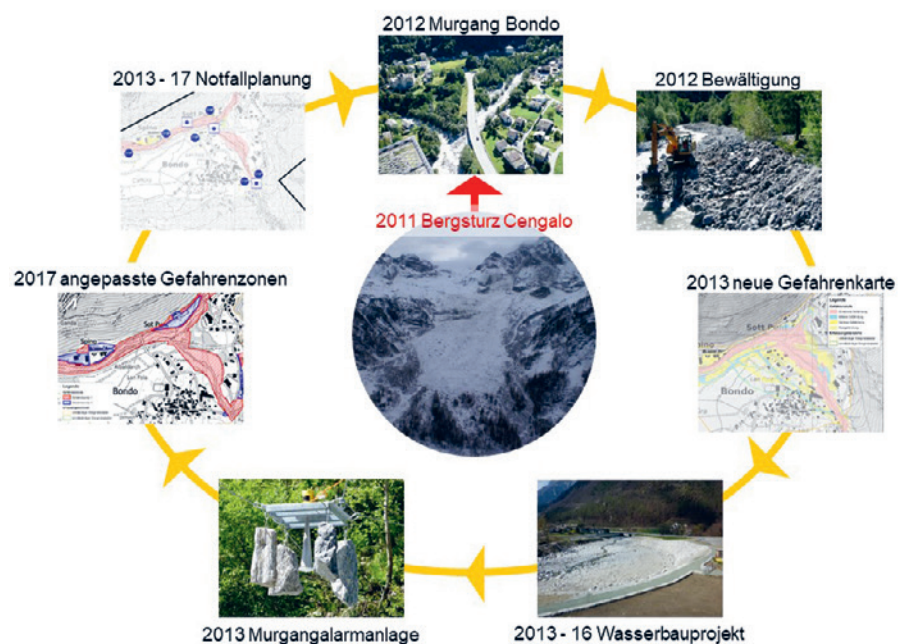
Abb. 3. Kreislauf des integralen Risikomanagements «Murgänge Bondo», der von 2012 bis 2017 zweimal durchlaufen wurde (vereinfachte Darstellung). Basierend auf einer neuen Gefahrenkarte wurden ein Auffangbecken gebaut, eine Murgangalarmanlage installiert, eine Notfallplanung mittels Interventionskarte erstellt und ein Frühwarndienst betrieben. Der Gefahrenzonenplan nach Massnahmen war verabschiedet und der lokale Naturgefahrenberater stand im Einsatz (Abb.: AWN).
