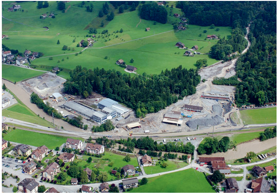
Abb. 4. Erhebliches Geschiebevolumen durch «Langzeitgeschiebetrieb» bei flächigem Niederschlag während 3 Tagen beim Wildbach Buholzbach 2005. Foto: Flugwaffe 2005.
