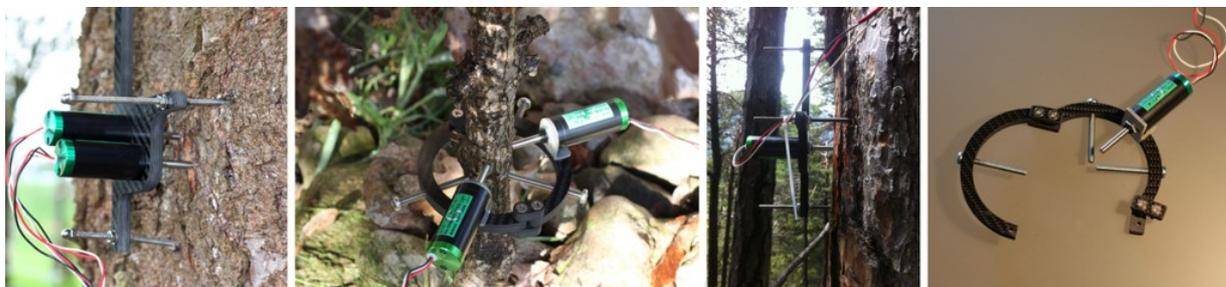
**Abbildung 4.** Verschiedene Modelle von Punktendrometern. Die Modelle mit den runden Rahmen lassen sich auch an dünnen Stämmen und an Ästen befestigen. Die verwendeten Daten in diesem Report stammen ausschliesslich von Messungen an der Stammbasis auf Brusthöhe.
