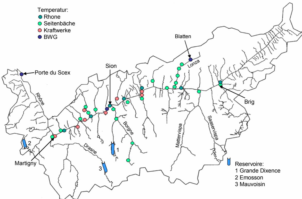
Abbildung 1: Die Rhone und ihre Zuflüsse mit Temperaturmessstellen (Kreise) und Reservoir mit Temperaturprofilen (U-Form).
