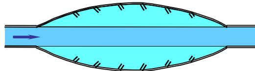
Bei der maschinellen Aufweitung wird die gesamte Verbreiterung des Flussbettes mit Hilfe von Baumaschinen herbeigeführt. Um eine weitere, meist unerwünschte Seitenerosion zu verhindern, sind Uferschutzmassnahmen (link) notwendig.
