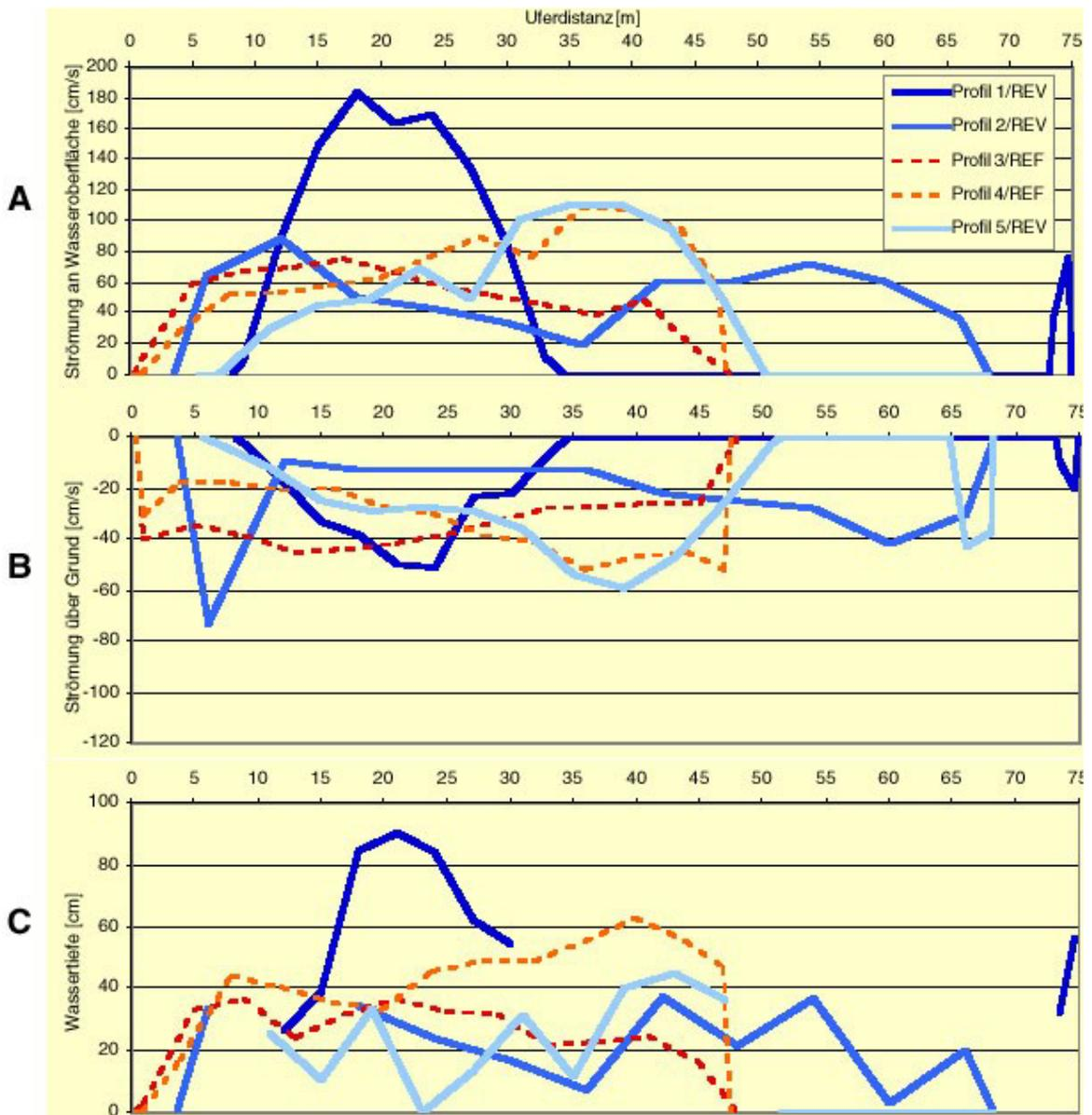
Abb. 3: Strömungsverhältnisse an der Wasseroberfläche (A) und über Grund (B) sowie Wassertiefen (C) der Thur zwischen Weinfelden und Niederneunforn (Limnex 2004)
