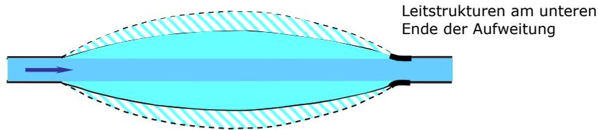
Wie bei der dynamischen Eigenentwicklung wird bei dieser Bauweise die Hauptarbeit dem Fluss selbst überlassen. Die Bildung der Ausweitung wird jedoch durch Initialmassnahmen (z.B. Uferabsenkungen, Aufschüttung von Inseln) beschleunigt, so dass die morphologische Gerinneveränderung und Neuschaffung von Auenlebensräumen relativ schnell zum Tragen kommen. Aus Sicht der „Ökologie“ ist dies daher die favorisierte Massnahme.
