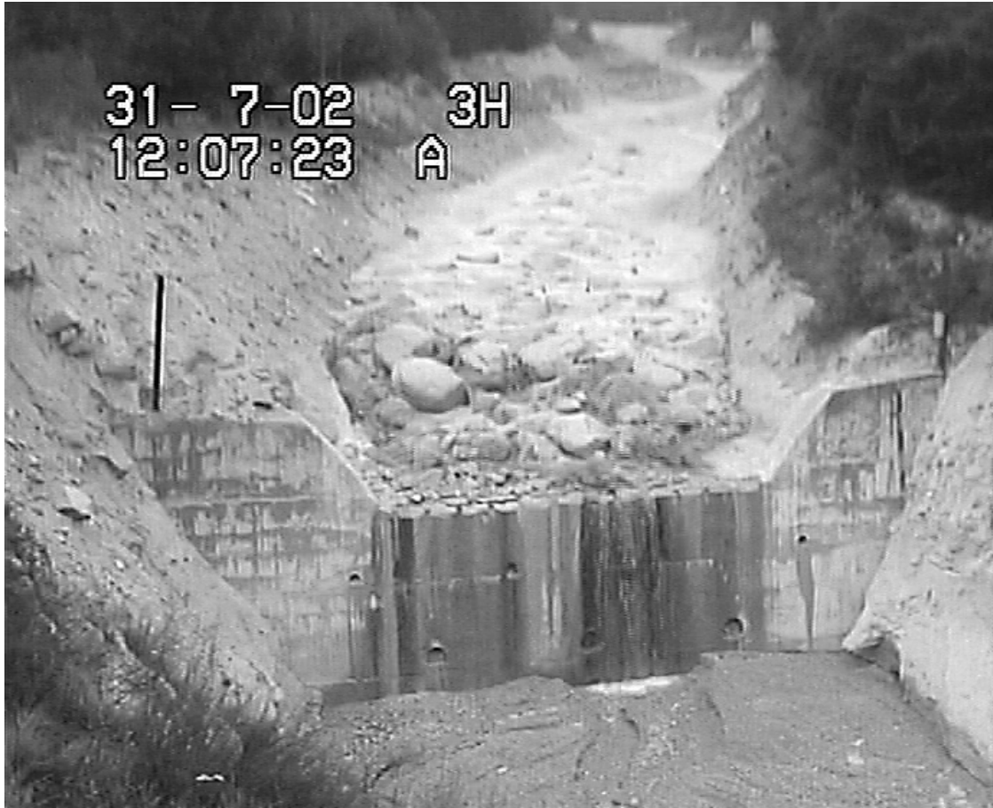
Bild 5: Videobild der Front des Murganges vom 31.7.2002. So wird die Wasser- und Geschiebemasse über die Sperre mit der Murgangwaage fließen. Die maximale Abflussmenge Q betrug bei diesem Ereignis 75 \text{ m}^3 / \text{s} , die mittlere Frontgeschwindigkeit 3 \text{ m/s} und die maximale Abflusstiefe 2.1 \text{ m} .
