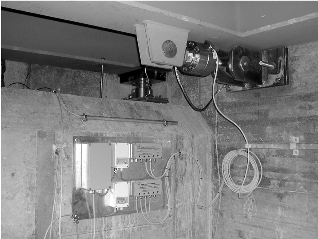
Bild 3: Messzellen zur Ermittlung der horizontal und vertikal auf die Murgangwaage wirkenden Kräfte und die Anlage zur Messumformung.
