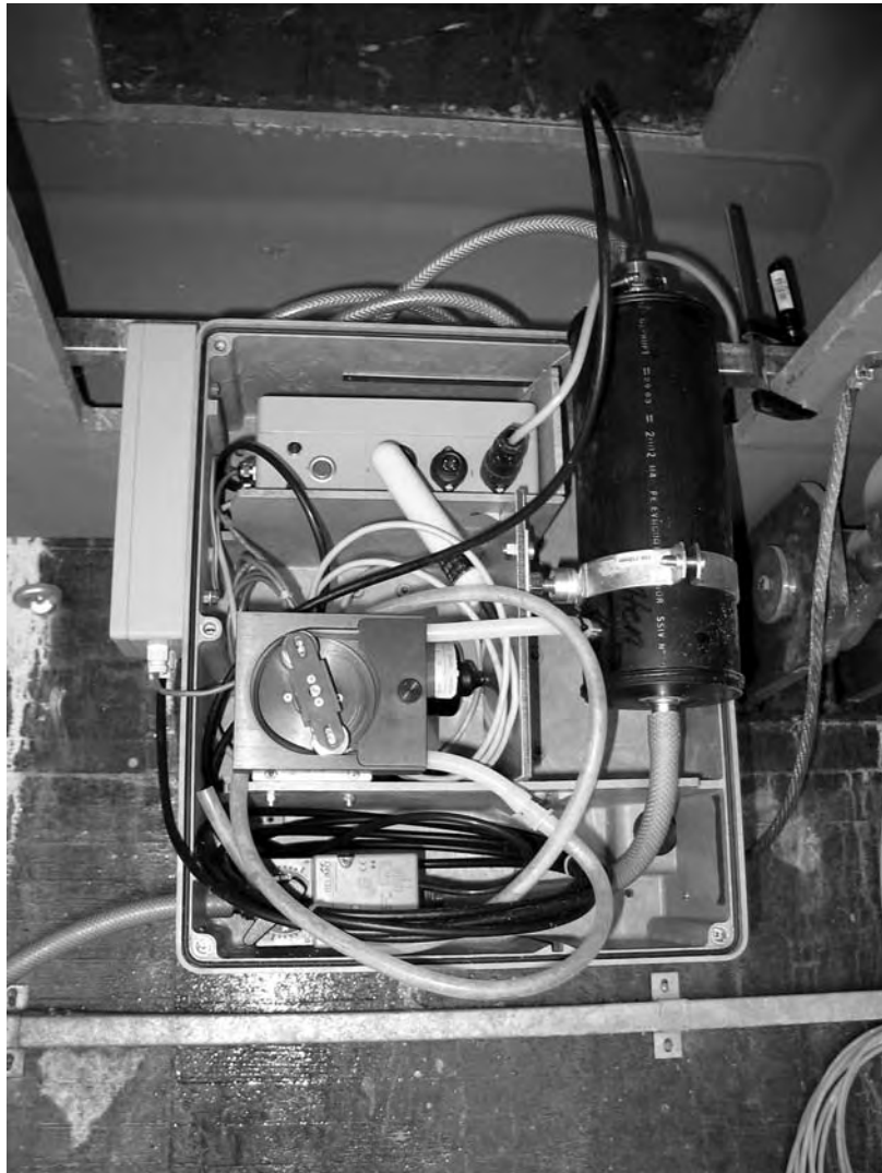
Bild 4: Anlage zur Messung des Porenwasserdrucks unterhalb der Murgangwaage.
