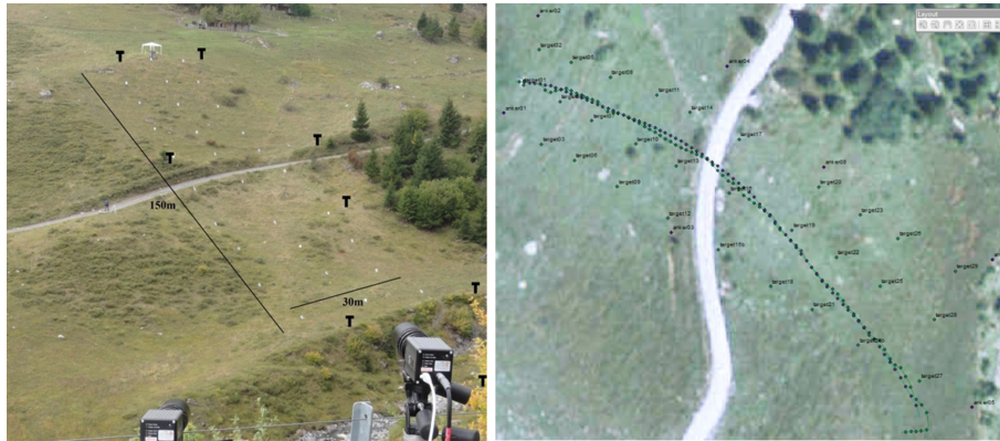
Abb. 4. Versuchshang (links, ca. 110 \times 30 m, ca. 30^\circ ) und Überlagerung von beobachteter und gemessener Flugbahn im GIS (rechts).
