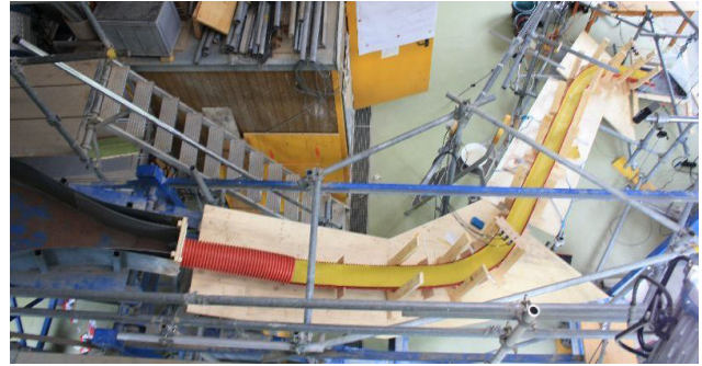
Abb. 1. Design des Experiments zur Untersuchung der Kurvenüberhöhung von Murgängen im Grossraumlabor der WSL. Am linken Rand ist der Startbehälter mit anschliessender Beschleunigungsstrecke zu erkennen. Daran anschliessend die Messstrecke mit zwei Richtungsänderungen unterschiedlicher Kurvenradien.
