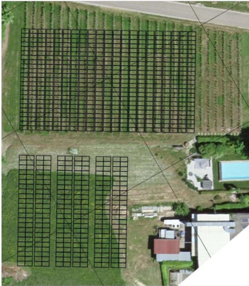
Abbildung 7: Skizze MBR-Solar vom 14.09.2024 "PV-Anlage Landenergie Schaffhausen". Modulfläche Reben (oben) 900-1'100 m 2 und Modulfläche Grünland (unten) ca. 550 m 2 . (MBR Solar, 2024)
