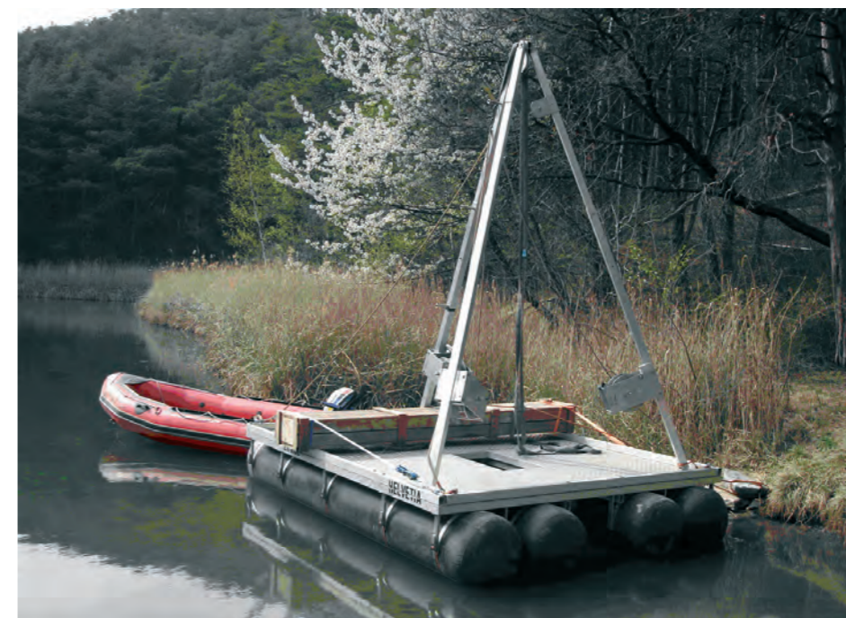
Fig. 1 — Kernplattform «Helvetia» mit Uwitec Hammer-Kolbenkernsystem.
