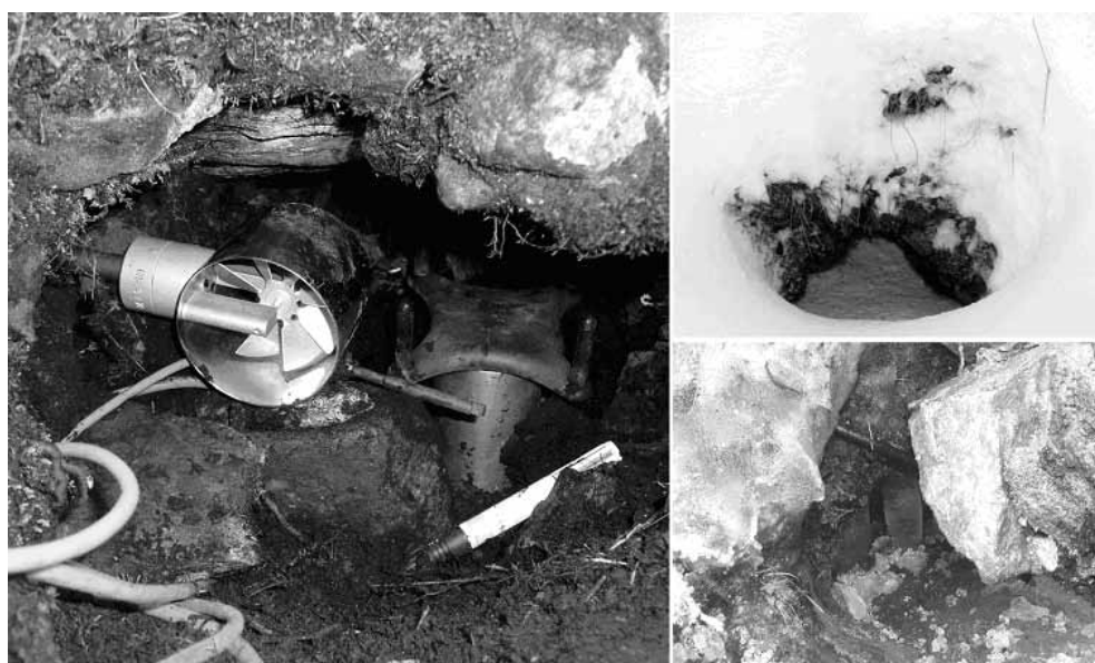
Fig. 3.3 - Équipement du trou à vent du Gros Chadoua avec anémomètres à ailettes et sonique, capteur de température et d'humidité en juillet 2007. À droite, le même trou en début d'hiver après une phase d'aspiration de neige profonde à l'intérieur du trou, et au printemps lors du regel des eaux de fonte de la neige.
