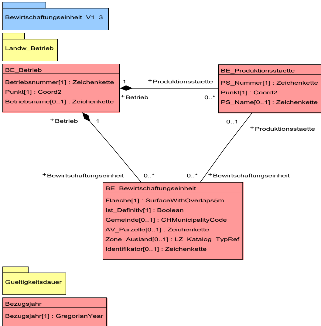
Figure 39 : Diagramme UML Unité d'exploitation
