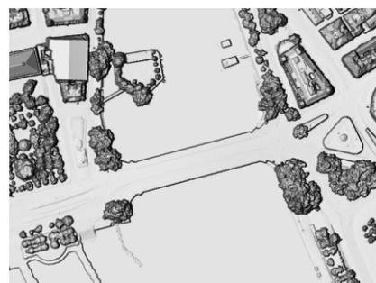
Abbildung 15: swissSURFACE<sup>3D</sup> Raster nach den Verbesserungen mittels Gewässervektoren und spike-free Algorithmus
