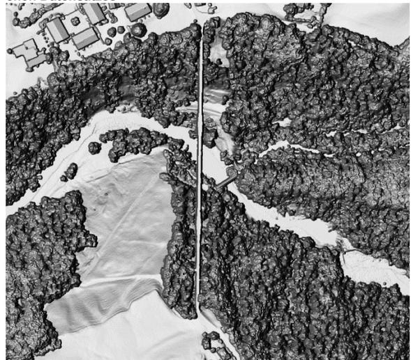
Abbildung 4: Gleicher Ausschnitt, multidirektionale Reliefschattierung des DOM swissSURFACE<sup>3D</sup> Raster
