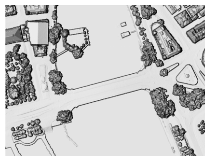
Figure 15: swissSURFACE 3D Raster après les corrections avec les vecteurs TLM et l'algorithme spike-free
