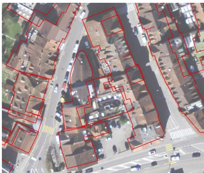
Figure 6: Exemple de la projection au sol des toits saisis en 3D dans une zone complexe.
