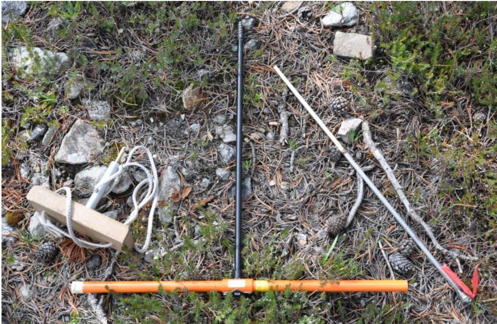
**Abbildung 22: Anbohrhilfe, Zuwachsbohrer und Lasche mit Bohrkern.**
