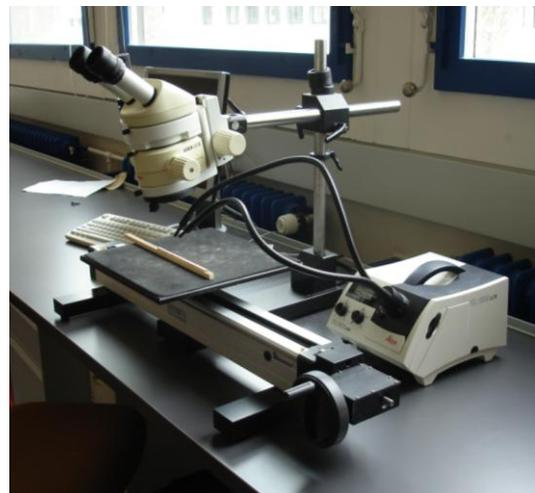
Abbildung 25: LINTAB Messtisch und Stereomikroskop.
