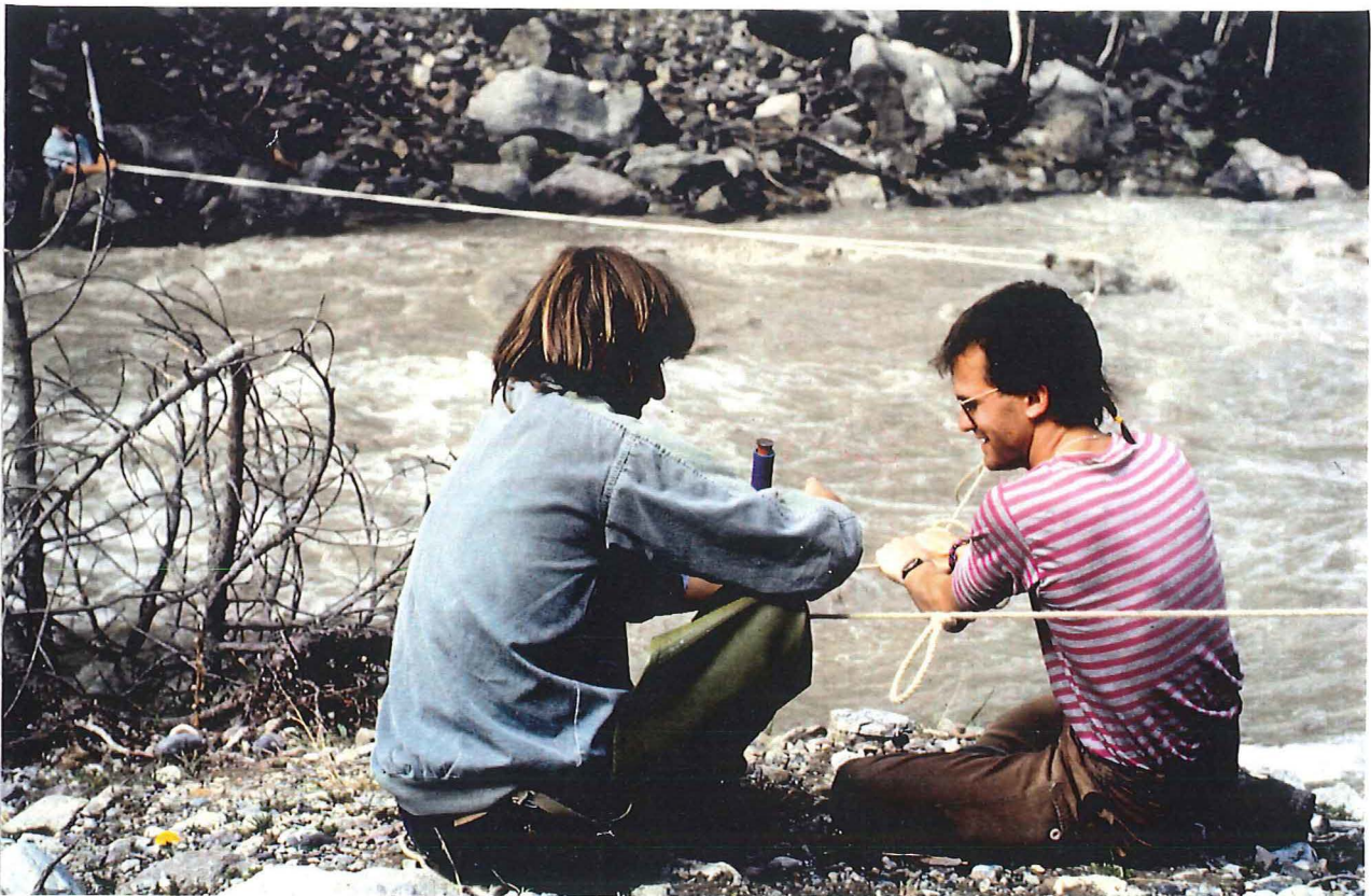
Drift-Probenahme während der Spülung an der Stelle SPÖ 1. Ein von beiden Ufern aus fixiertes, resp. gehaltenes Driftnetz mit definierter Öffnungsfläche wird eine bestimmte Zeit in der fließenden Welle exponiert (während Spülung ca. 1-2 Min.) und erfasst so die weggespülten und verdrifteten Kleinlebewesen.
