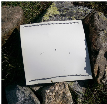
Abbildung 16: Passpunktsignalisation für UAV
