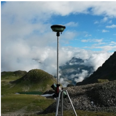
Abbildung 11: GNSS-Messung mit Strebenstativ
