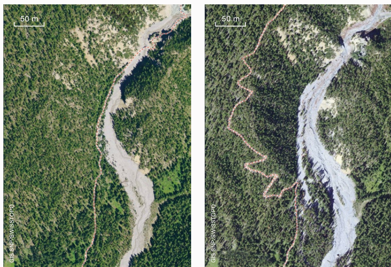
Abb. 8 Das linke Bild zeigt den vorderen Teil der Val da Stabelchod vor (2016) und nach (2019) dem Murgang vom 23. August 2018. Links der alte Wegverlauf, rechts der neue.
