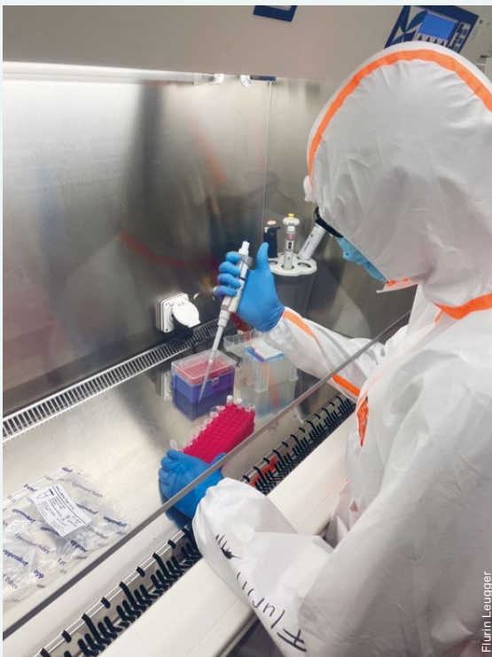
Abb. 3 Aufgrund der geringen DNA-Konzentrationen in der Umwelt gilt es jegliche Kontamination zu vermeiden. Deshalb werden die Proben in speziellen Labors (UV-Licht, Luftfilter) und mit strengen Vorschriften (zum Beispiel Ganzkörperanzug) extrahiert.
