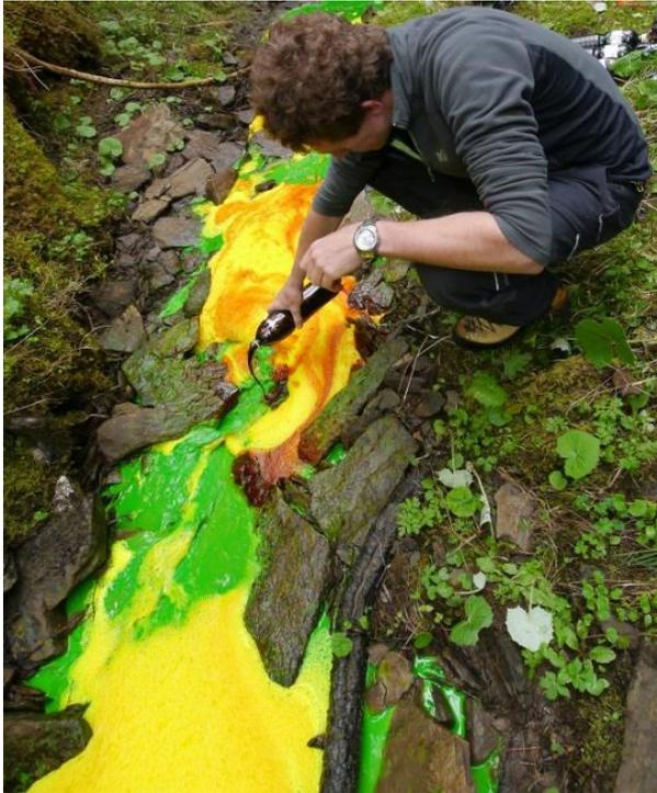
Abbildung 3-1: Einbringen des Tracers Uranin; Eingabelösung: dunkelrot, Verdünnung: fluoreszierend grün
