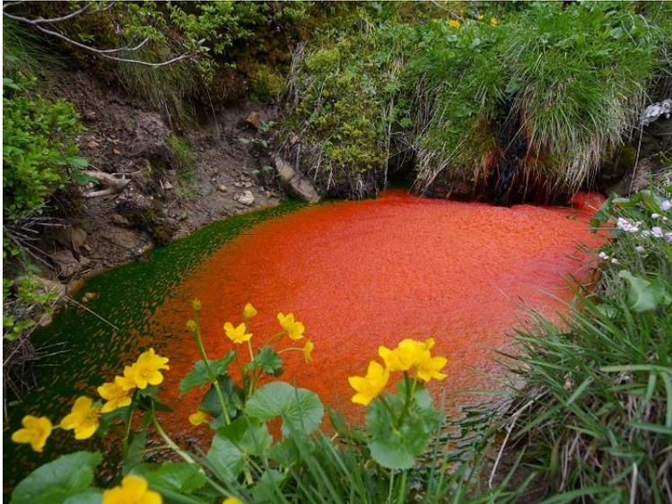
Abbildung 3-2: Tracer Eosin direkt nach der Zugabe
