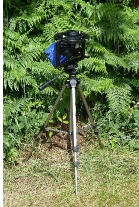
Abbildung 2: Fischaugenkamera auf selbstnivellierendem Kamerahalter.
