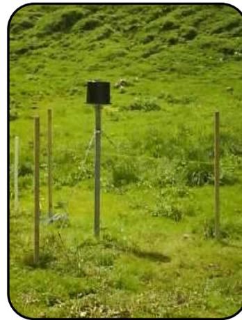
Abb. 4-11: Niederschlagsstation Rainwise (Station F: Eisee) mit Umzäunung.
