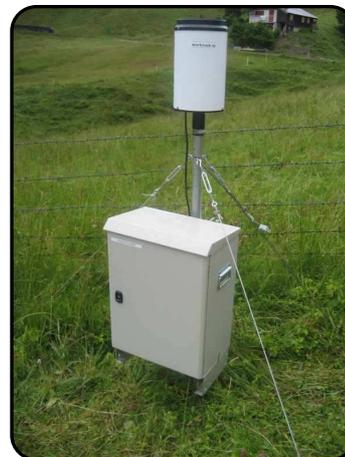
Abb. 4-9: Niederschlagsstation (Station B: Ruchweid) mit Niederschlagsmessgerät Young und Loggerkasten.
