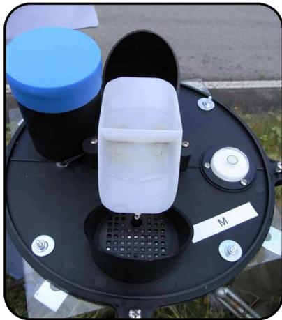
Abb. 4-10: Rainwise-Niederschlagswippe ohne Messtrichter (Station M: Hintere Rotbach).
