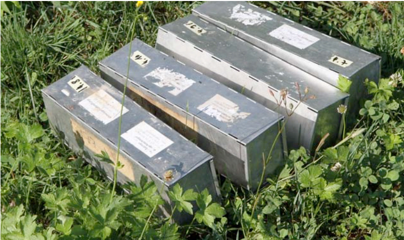
Abbildung 2: Sherman-Lebendfallen, die Öffnung befindet sich an der Stirnseite und ist auf dem Bild geschlossen (Foto: © Klaus Robin)
