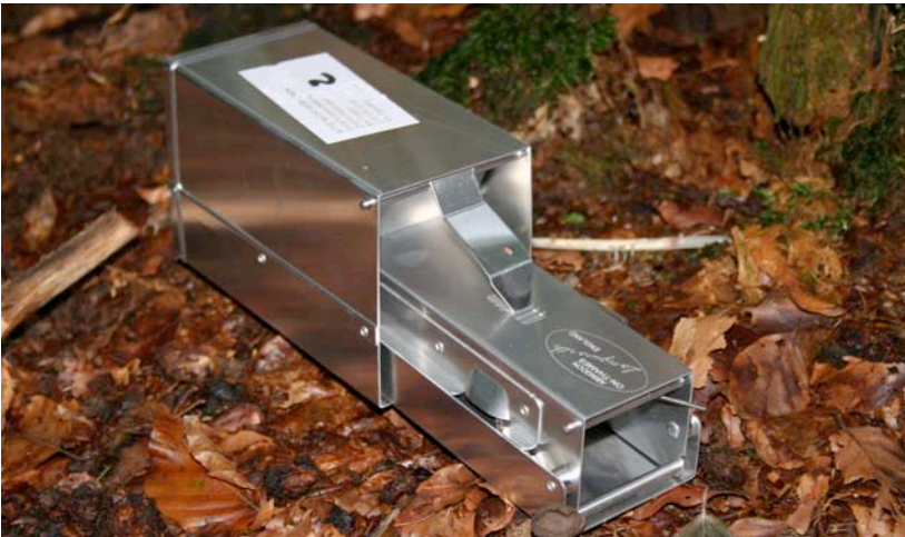
Abbildung 1: Longworth-Lebendfalle mit geöffnetem Eingangstunnel (Foto: © Philip Danuser)
