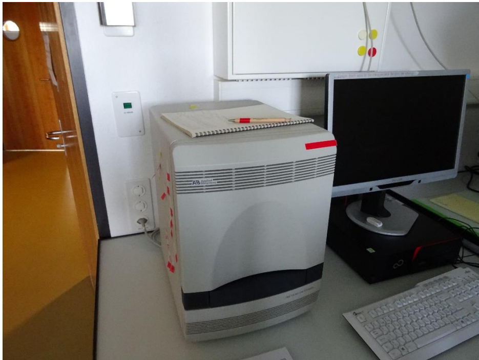
Abbildung 14: Das 7500 Real-time PCR System von Applied Biosystems, in dem die Analyse stattfand.
