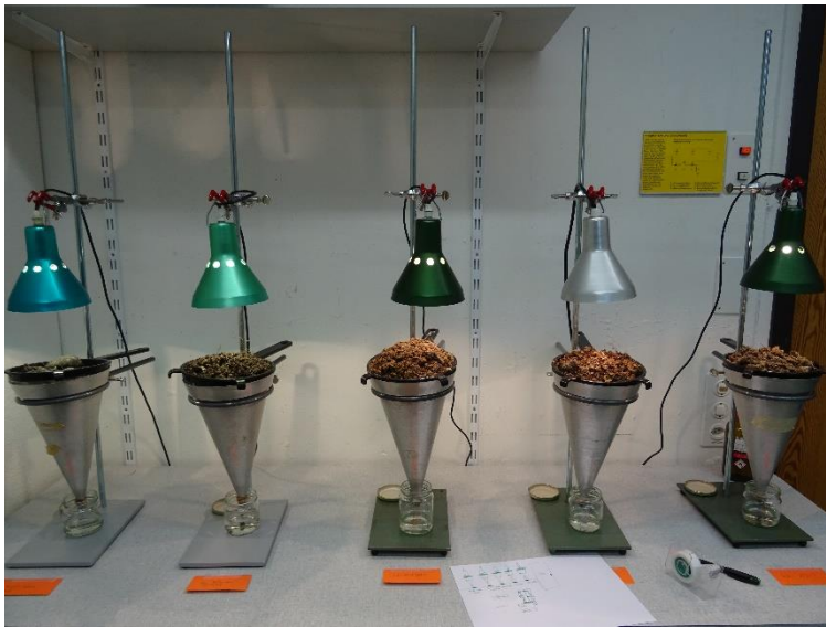
Abbildung 8: Aufbau der Berlesetrichter in einem Labor der WSL
