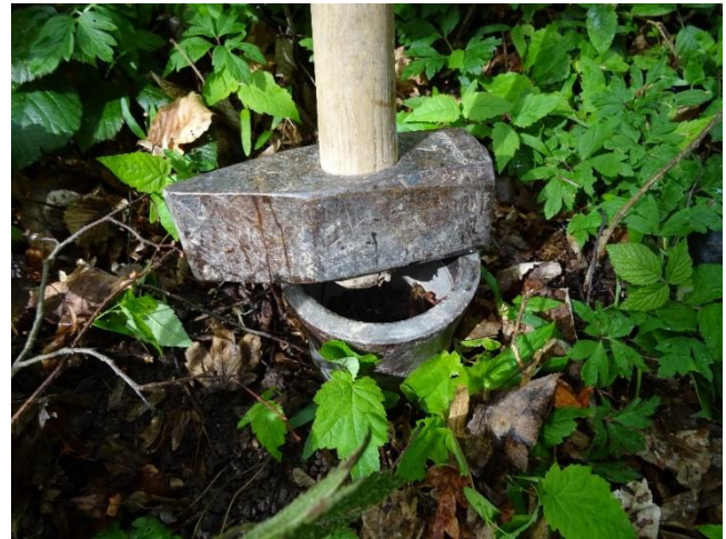
Abbildung 2: Hereinschlagen des Burgerzylinders in den Waldboden
