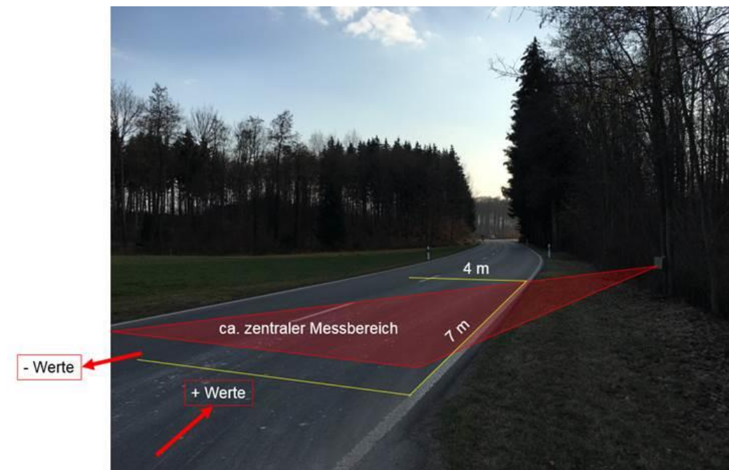
Abb. 4: Schematische Darstellung des Messbereichs eines Sierzega-Messgeräts (Quelle: Peter Ryser, Kantonspolizei Zürich)
