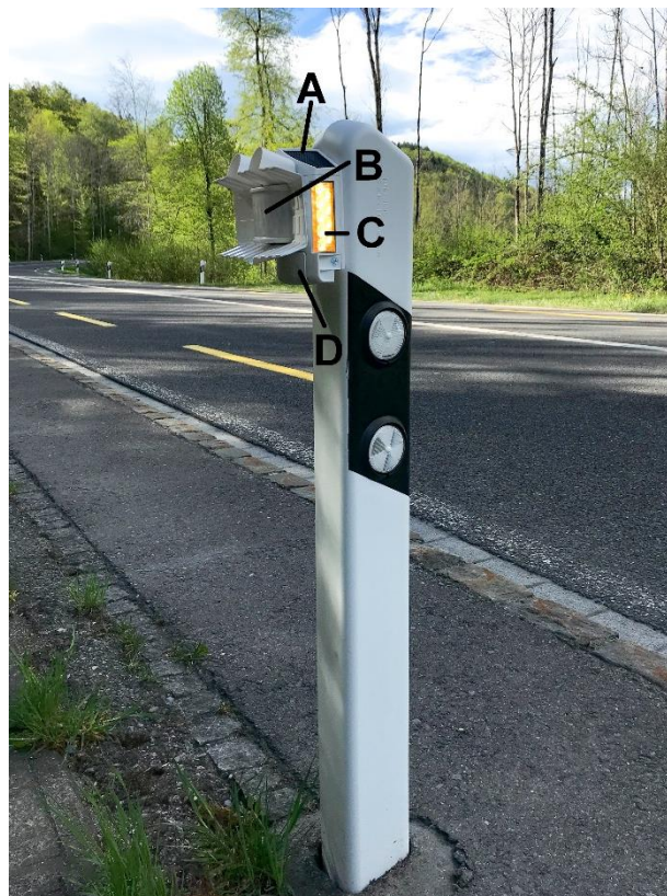
Abb. 1: Hauptbauteile eines AniMot-Moduls: A) Solarmodul, B) Erkennungssensor, C) LED-Warnsignal, D) Akkufach
