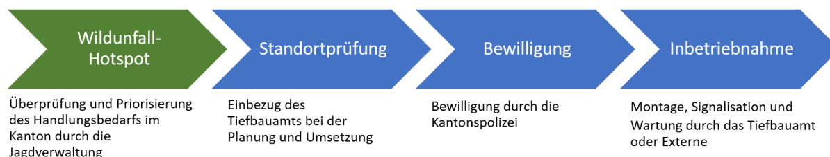
Abb. 22: Möglicher Ablauf für die Inbetriebnahme einer AniMot-Wildwarnanlage
