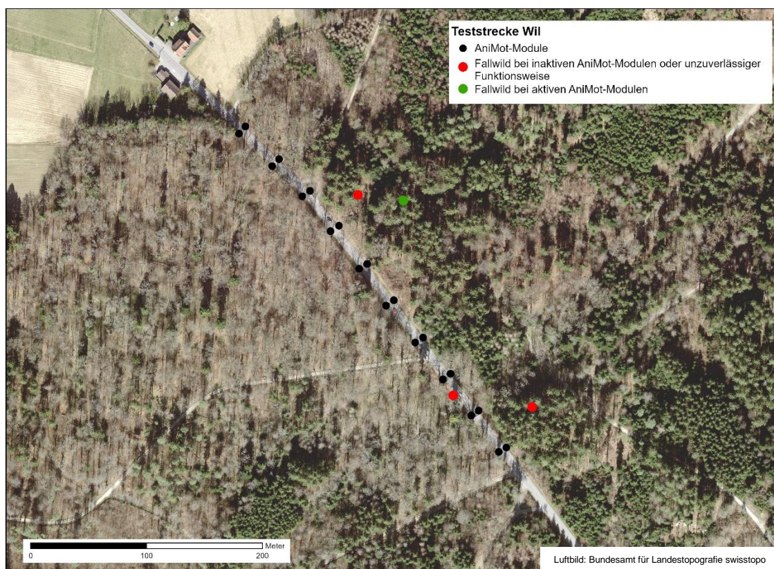
Abb. 14: Wildtierunfälle an der Teststrecke Wil ZH zwischen März 2019 und März 2021. Bei aktiviertem AniMot Wildwarnsystem wurde am 24.9.2020 ein Reh angefahren. Bei inaktiven AniMot-Modulen am 21.4.2019 ein Reh und am 6.7.2019 zwei Sikahirsche (Kuh & Kalb). Beim Wildtierunfall mit einem Reh am 17.8.2019 haben die AniMot-Module nicht ausgelöst (mündl. Mitteilung Ueli Hug, Jagdgesellschaft Wil).
