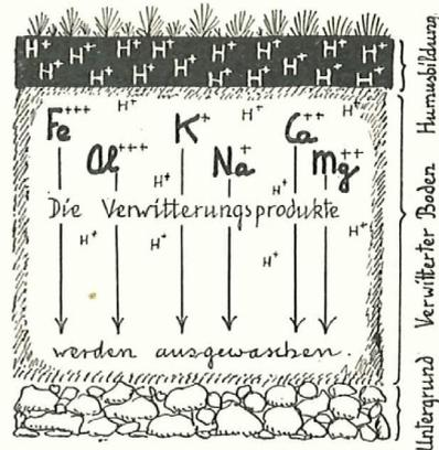
Fig. 1. Schema der H<sup>+</sup>-Anreicherung.
