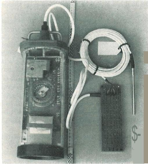
Abb. 25 Temperaturmessgerät «Datalogger DL-1». Die Mess- und Registrierapparatur ist durch eine wasserdichte Hülle geschützt. Die Fühler können für Bodeii- und Lufttemperaturmessungen verwendet werden.
