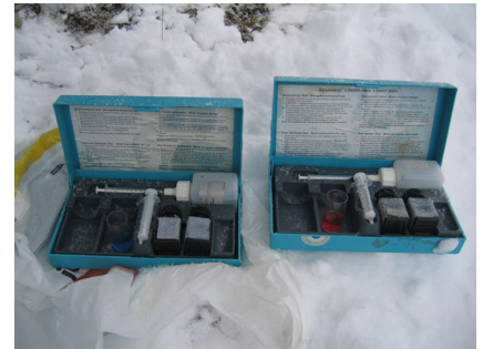
Abbildung 3.3 Die Aquamerck-Härtetests im Einsatz (Foto: A. Graf)
