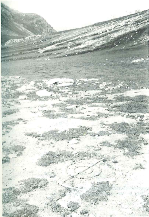
Foto 1 Übersicht zur Lokalität westlich des Munt Chavagl auf 2400 m, wo 1970 auf einem Erdkuchen mit zwei konzentrischen Kreisen Experiment Nr. 2 ausgelegt worden ist. Ein Klappmeter weist dabei 1 m in Richtung des 1-2° betragenden Gefälles. Im Hintergrund sind die von FURRER et al. (1975) untersuchten Erdströme sichtbar.
