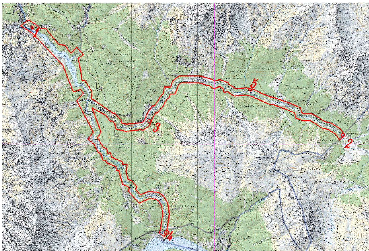
Abbildung 2: Passpunkte für Aerotriangulation (Punkte 1-5) und Kontrollflächen für Kontrolle des DTM (Punkte 1, 2 und 4)
