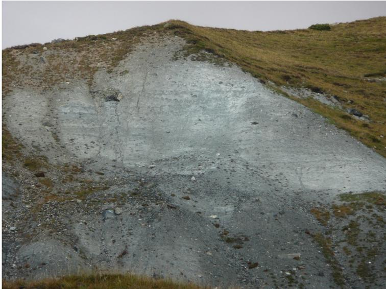
Abb. 40 Teil des Lockergesteinsaufschlusses mit Serpentin bei Jonvrai mit Blick nach Norden, wo die Materialprobe 255 genommen wurde. Steile Kanten, wie oben links im Bild wurden in der Quartärgeologischen Karte mit einer roten Anrisslinie nachgezeichnet.
