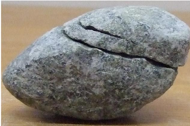
Abb. 52 Gut gerundeter Serpentiniklast der Probe 274. Der obere Teil des Gesteins wurde, aufgrund von Schubbeanspruchung unterschiedlich schnell bewegender Komponenten, abgesprengt.
