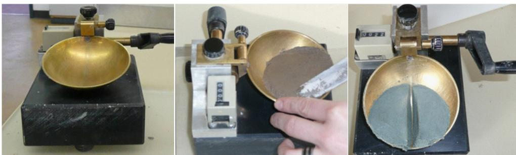
Abb. 21 Apparatur nach Casagrande. In die „goldene Schale“ wurden die Proben mit ca. 1 cm Dicke eingearbeitet.
