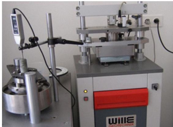
Abb. 25 Kreisring- und Rahmenschergerät im geotechnischen Labor in Burgdorf.
