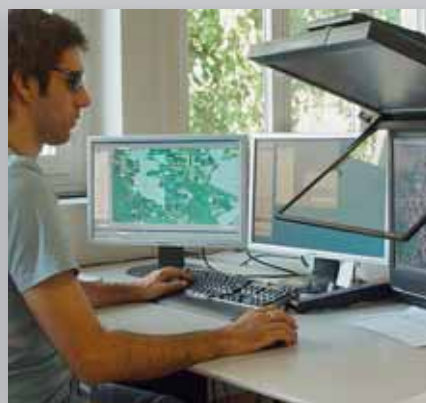
Abbildung 3: TOPGIS-Arbeitsplatz: Die beiden Bildschirme links dienen der Steuerung der Software und der Bearbeitung der Daten. Der Bildschirm auf der rechten Seite ist der 3-D-Stereo-Bearbeitungsschirm für die stereoskopischen Auswertungen. (© 2009 swisstopo)
