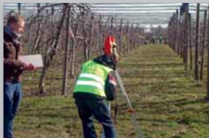
Figure 2 : relevé des cultures par théodolite électronique. Photo de D. Laffely, enseignant au CEPM
