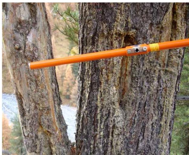
Abb. 12: In die Verletzungsfläche eingedrehter Dendroböhrer
