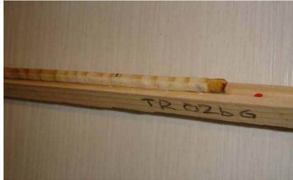
Abb. 12: Trägerholz mit aufgeklebtem und zugeschnittenem Bohrkern TR02bG, bereit für das Stereomikroskop
