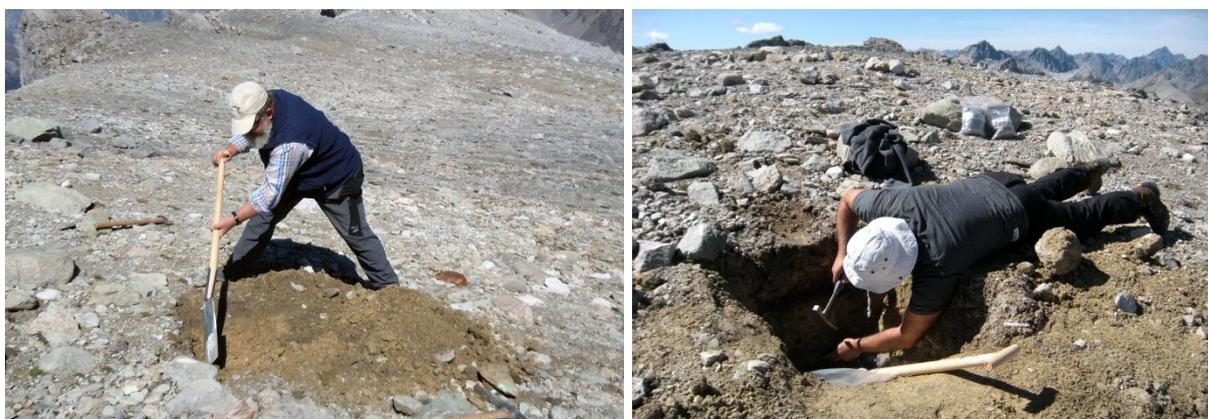
Abb. 29: Aushebung für ein Tiefenprofil (links) und Probennahme für die Datierung (rechts), September 2011.
